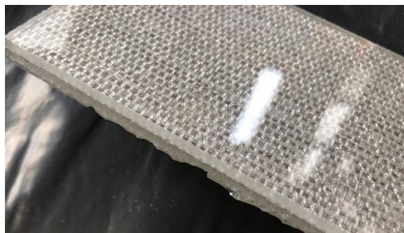
Рис. 14 Пример кромки, образовавшейся в результате гидроабразивной резки, в которой было использовано слишком мало абразива и скорость резки была слишком высокой - верхний слой стекла
